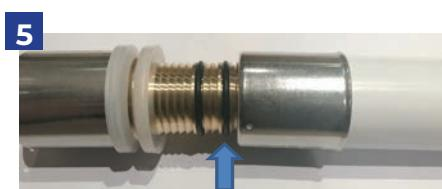
Luego, inserte el cuerpo del accesorio en el tubo con el casquillo. Insértelo cuidadosamente y verifique visualmente que las juntas tóricas no estén dañadas ni se dañen en el montaje.
