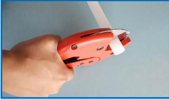
1. Es muy importante cortar el tubo de manera limpia y perpendicular a su eje.
