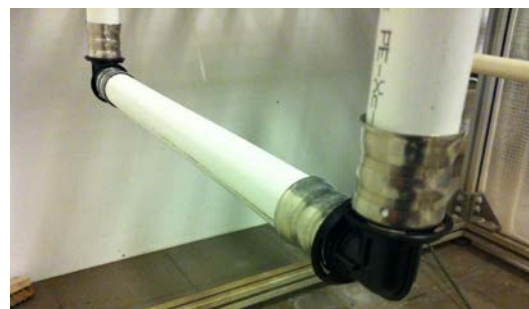
ENSAYO DE CICLOS DE TEMPERATURA AC-FIX PRESS DUO (PPSU) CON TUBOS MULTICAPA
