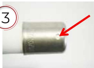
Coloque el casquillo de acero inoxidable en el extremo de la tubería hasta el fondo, de modo que la tubería se pueda ver totalmente a través de los orificios indicadores.
