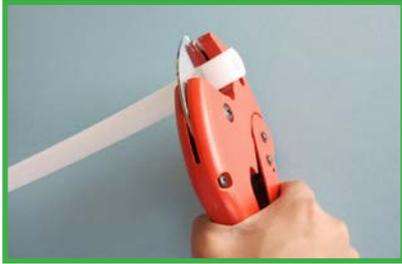
**1.** Es muy importante cortar el tubo de manera limpia y perpendicular a su eje.
