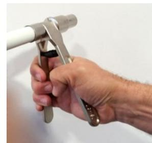
Inserte el accesorio completamente. El tubo debe verse completamente a través de los orificios indicadores del casquillo de acero inoxidable. El extremo del casquillo de acero inoxidable debe alcanzar el anillo de plástico (negro o blanco). No dejar más de 1,5 mm entre el extremo del casquillo de acero inoxidable y el anillo de plástico.
