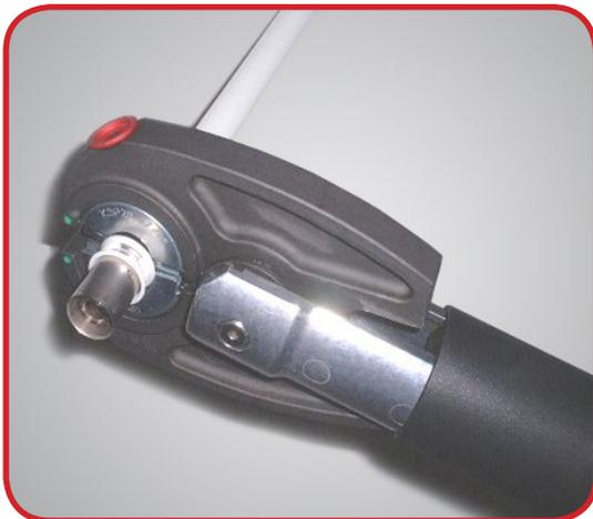
**3.** Posicionar el lateral de la mordaza al lado del anillo de plástico y realizar el prensado con mordazas U, RF o RFz. El anillo de plástico no debe prensarse.
