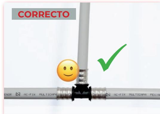
Cuando haya que curvar o enderezar un tramo de tubería cercano a una unión, debe sujetarse la tubería en la zona próxima a la unión con el fin de no transmitir la tensión al accesorio. Ésto es aplicable a todos los accesorios pero más especialmente a los de PPSU. Por ésto, es mejor enderezar los tubos de rollos antes de conectarlos a los accesorios.
