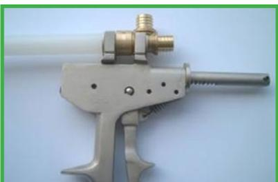
**7.** Accionar la palanca móvil hasta que el casquillo toque el cuerpo del accesorio.
