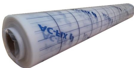
Además cuenta con una cuadrícula guía de 10 cm de ancho para ayudar en la instalación, corte y solape de capas que según la norma anterior citada debe ser de un mínimo de 8 cm.
