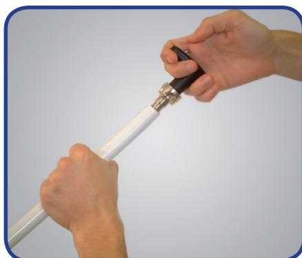
2. Calibrar y biselar el extremo del tubo dónde se vaya a introducir el accesorio. Este paso es importante para no dañar las juntas tóricas. El calibrador AC-FIX calibra el interior y exterior del tubo.
