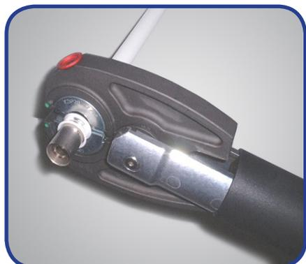
4. Posicionar el lateral de la mordaza al lado de la junta plástica y realizar el prensado.
