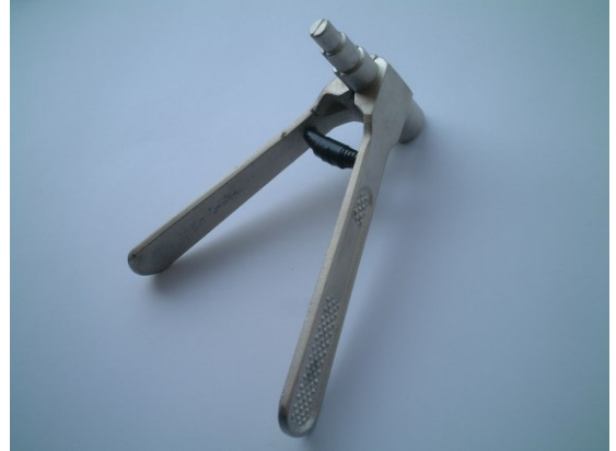
ABOCARDADOR 12-25 PINCE À EMBOÎTURE AC-FIX 12-25
